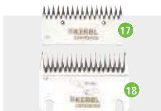
7315-1118-000 Juego de cuchillas 18/17 para el esquila de vacunos de pelo tupido y ovejas de lana fina, longitud de pelo restante: aprox. 2-3 mm
