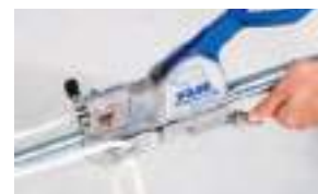
Limitador de fuerza de tracción ajustable
